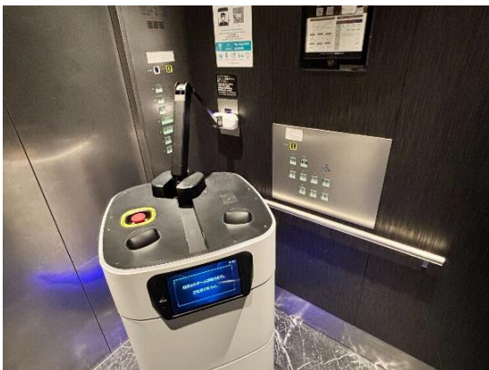
頭部のアームでエレベーターのボタンを押したり、配達を知らせるために客室のドアをロックする事も可能
