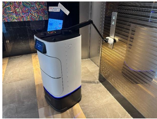
頭部のアームでエレベーターのボタンを押したり、配達を知らせるために客室のドアをロックする事も可能
